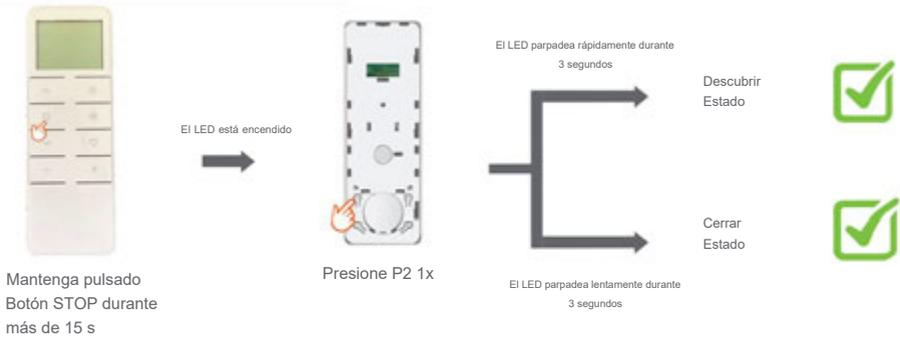
**NOTA** Con la función de bloqueo no se pueden programar funciones en las que se necesitan dos botones como ajustes de límites y cambio de dirección.
