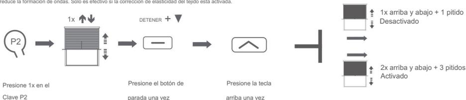
**i** La función de retroceso libera la tensión de la tela en la posición superior. Desactivada por defecto.
