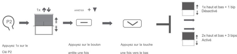
La fonction de rétraction assure le maintien de la tension de la toile en position basse. L'option par défaut est désactivée.
