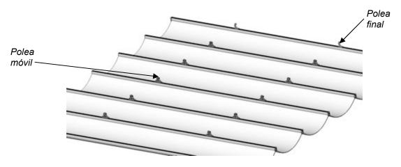
A continuación, y previo desmontaje del tornillo y rodillo de redirección de la correa del soporte motriz, se procederá a introducir las poleas móviles en las guías por los huecos inferiores de dichos soportes. Habrá que tener en cuenta que las poleas de arrastre estén lo suficientemente separadas de los soportes para dejar espacio a todas las poleas móviles que se colocarán detrás de ellas.
