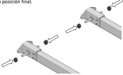
A continuación, se montará el tubo de transmisión introduciendo en primer lugar un extremo del tubo en el eje cuadrado de una de las guías. Seguidamente, desplazamos el eje de la otra guía de forma que nos permita introducir éste en el otro extremo del tubo de transmisión. Por último, dejamos los ejes en su posición final y apretaremos los prisioneros de los frenos.
