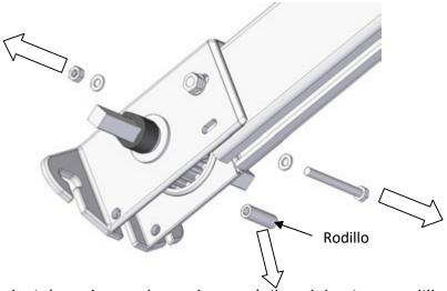
Se introducirán a la vez las poleas móviles del mismo palillo en sus respectivos soportes motrices, empezando con la inmediatamente posterior a la de arrastre y continuando progresivamente en orden hasta la polea final, la cual se colgará en el tornillo DIN933 M8x65 del soporte que se montará para tal fin. No obstante, antes de colocar ésta, habrá que poner de nuevo el tornillo con el rodillo de redirección (DIN933 M6x60) para evitar que se caigan las poleas móviles al recoger el toldo.
