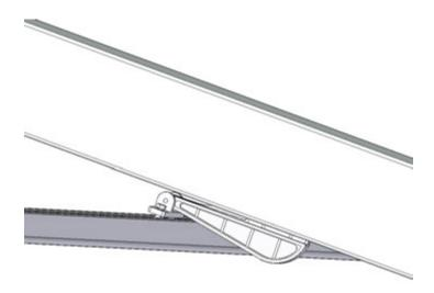
Para finalizar, se tensará la correa apretando los tornillos DIN 912 M8X60 del soporte retorno. El apriete de ambos tornillos deberá hacerse de forma alternativa para evitar el atranque de la correa y el gripado de los tornillos. El tensado recomendado será dándole una vuelta más a los tornillos DIN 912 M8x60 una vez que la correa haya quedado oculta en la guía.
