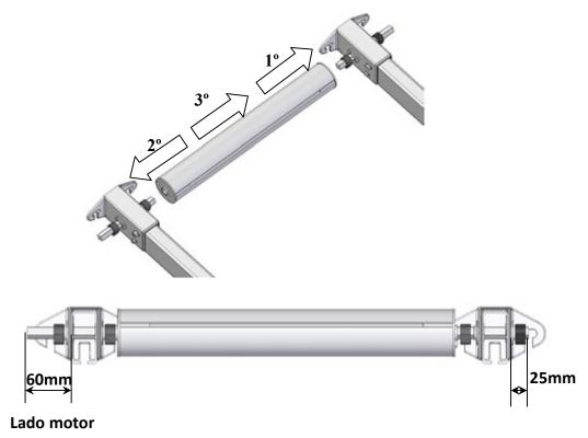
Finalmente, se montará el motor introduciendo el extremo libre del eje cuadrado por el casquillo del tubo de transmisión del motor y fijando su otro extremo a la estructura o pared mediante la escuadra soporte.
