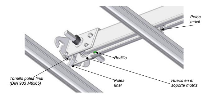
Posteriormente, uniremos el primer palillo con las poleas de arrastre mediante las regletas previamente introducidas en éste.
