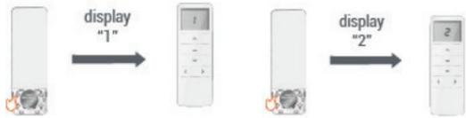
Retire la batería. Presione el botón P2 mientras reemplaza la batería.
