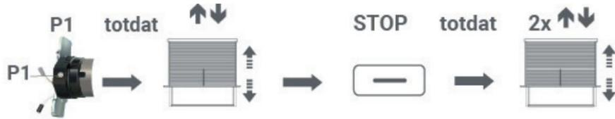
Presione el botón P1 hasta que el motor suba y baje una vez. Luego presione el botón de parada del control remoto hasta que el motor suba y baje dos veces. El control remoto ya está conectado al motor. Repita el procedimiento para desconectar el motor. ¿No puede hacerlo? Verifique si el control remoto está en modo bidireccional.
