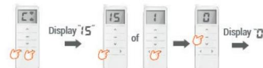
Presione ambos botones de canal simultáneamente hasta que aparezca 15 en la pantalla. Utilice el botón del canal izquierdo o derecho para seleccionar la cantidad de canales. Pulse el botón STOP una vez para confirmar.
