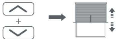
Mantenga presionados simultáneamente los botones ARRIBA y ABAJO hasta que el motor se mueva hacia arriba y hacia abajo. La dirección de rotación ahora ha cambiado. ¿No puedes hacer esto? Comprueba si el control remoto está bloqueado.
